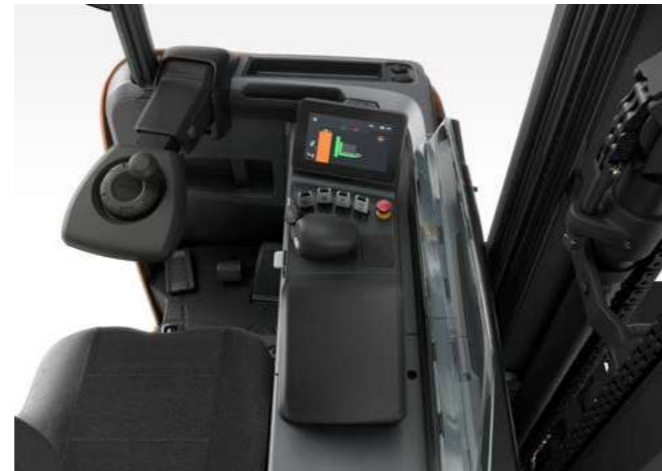
La cabine est conçue de manière ergonomique autour de l'opérateur, offrant un poste de travail confortable avec toutes les commandes à portée de main.
