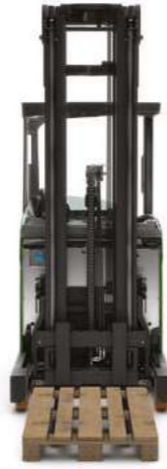
Le châssis étroit du CESAB R200 facilite la manutention des palettes EUR entre les bras de support.
