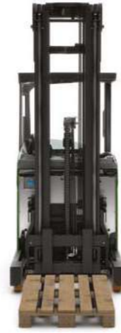
El chasis estrecho de la CESAB R200 facilita la manipulación de palés EUR entre los brazos de soporte.
