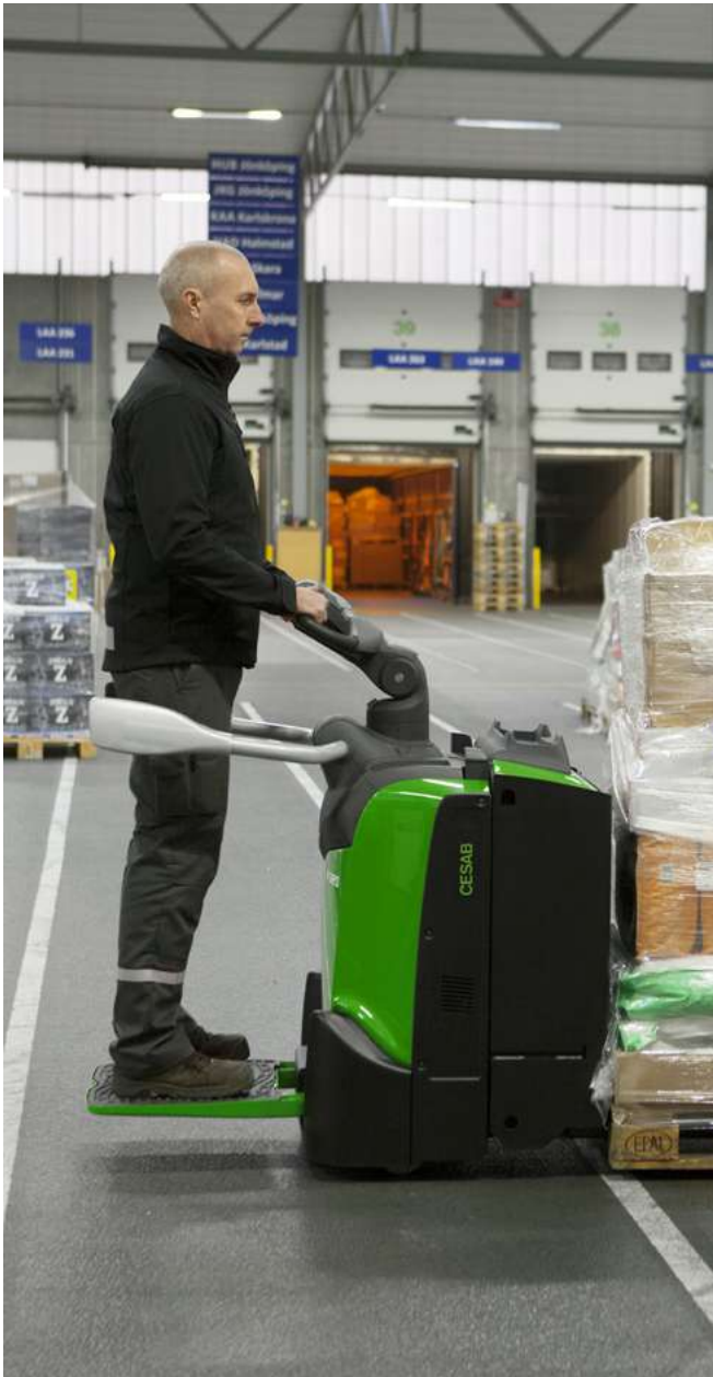
La hauteur du bras de direction peut être réglée d'une simple pression sur un bouton.
