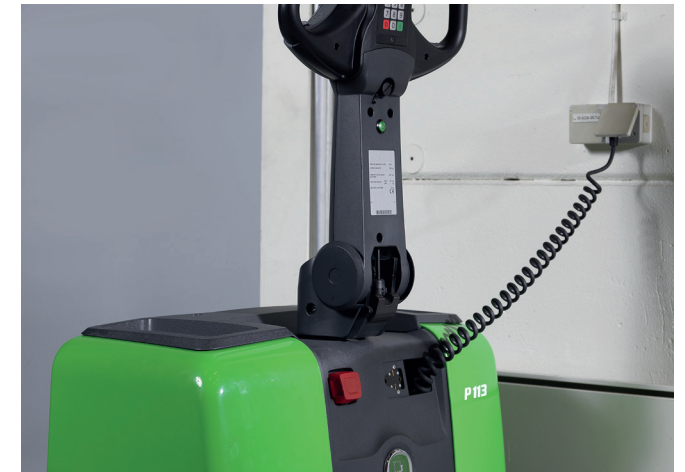
Das Bedienfeld verfügt über ein ausziehbares Netzkabel für das integrierte Ladegerät.
