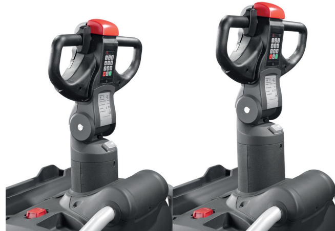
Die Höhe des Lenkarms lässt sich per Knopfdruck einstellen.
