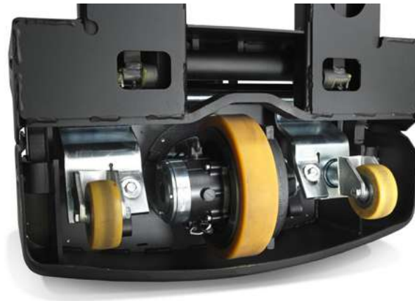
Das einzigartige Castorlink-System schützt die Lenkrollen auf unebenen Oberflächen.
