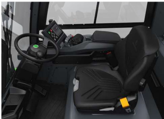
Accoudoir ergonomique avec choix de mini-leviers adaptés à votre style de conduite.
