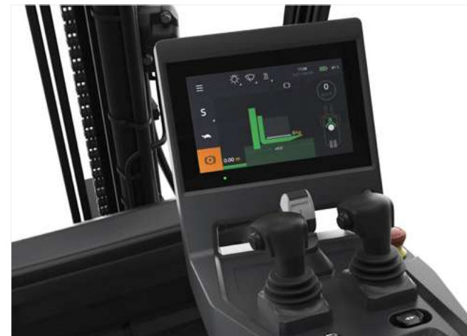
Grand écran tactile couleur fournissant des informations essentielles et contribuant à la productivité du conducteur.
