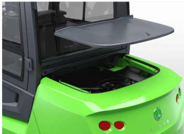
Fácil acceso para el mantenimiento gracias a la tapa extraíble del contrapeso, lo que reduce los costes y el tiempo de inactividad.
