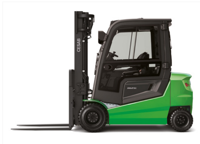
Der vollständig entkoppelte Fahrerraum isoliert den Fahrer von Vibrationen und Lärm für mehr Komfort und Produktivität.
