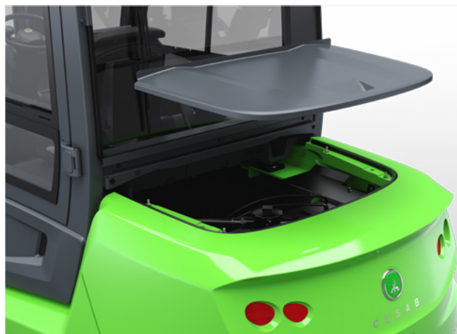
Einfacher Wartungszugang über abnehmbaren Gegengewichtsdeckel, wodurch Kosten und Ausfallzeiten reduziert werden.
