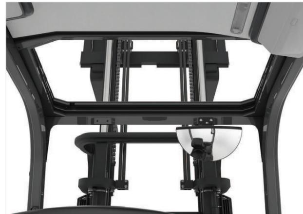
Visión clara de las puntas de las horquillas a través de todos los mástiles, el techo de cristal transparente (opcional) permite realizar operaciones de manipulación seguras y eficientes al tiempo que aumenta la comodidad y la productividad del conductor.
