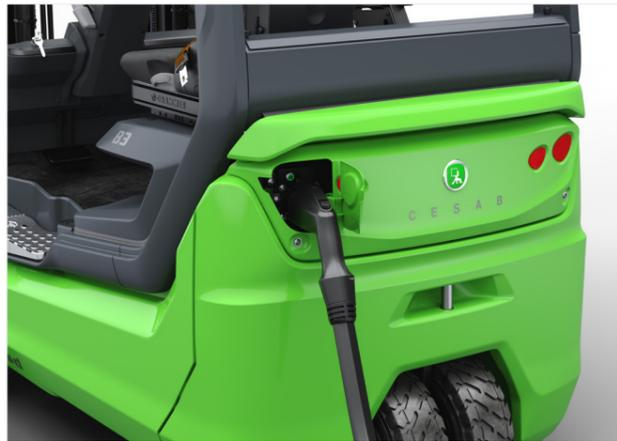
El conector de batería es fácilmente accesible en la parte trasera de la carretilla, integrado en el contrapeso, lo que permite una rápida carga de oportunidad, maximizando el tiempo de actividad.
