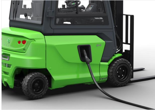
El modelo convencional puede equiparse con batería de iones de litio. Un fácil acceso al enchufe de la batería en la puerta lateral permite una carga de oportunidad fácil, rápida y segura.
