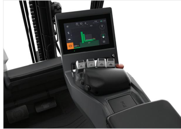
Las opciones de pantalla y palancas se han diseñado pensando en el operador para ofrecerle una comodidad y productividad óptimas. La pantalla táctil en color es intuitiva e interactiva y muestra los parámetros y controles esenciales.
