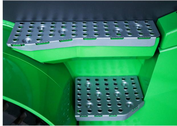
La gran facilidad de entrada con amplios escalones y las asas dobles de ayuda al conductor garantizan que se reduzca la fatiga al mínimo en aplicaciones que requieren entrar y salir repetidamente.
