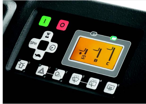
El preselector de altura de elevación ahorra tiempo y esfuerzo al conductor.
