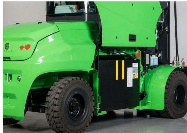
El diseño de chasis abierto con puerta lateral facilita el intercambio de la batería
