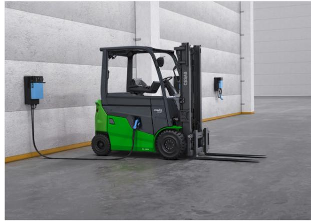
Los últimos packs de energía inteligentes de CESAB, basados en baterías y cargadores de iones de litio, permiten ahorrar costes y energía.
