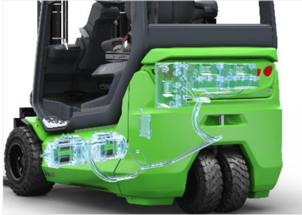
StaminaTune de CESAB junto con los motores IPM (imán permanente interior) combinados con nuestros avanzados controladores, ofrece un rendimiento mejorado, al tiempo que minimiza el consumo de energía.
