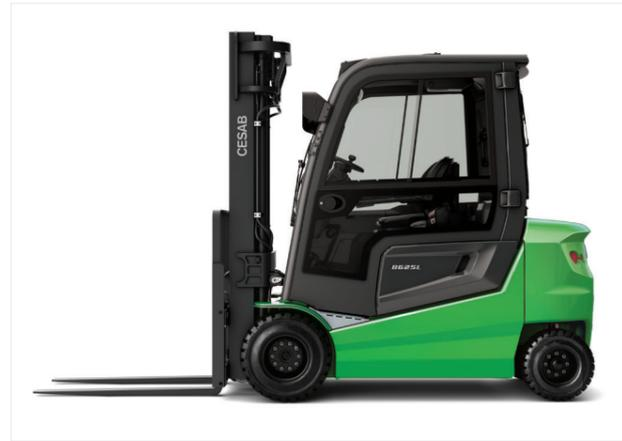
El compartimento del conductor totalmente flotante aísla al conductor de vibraciones y ruido para mejorar el confort y la productividad.
