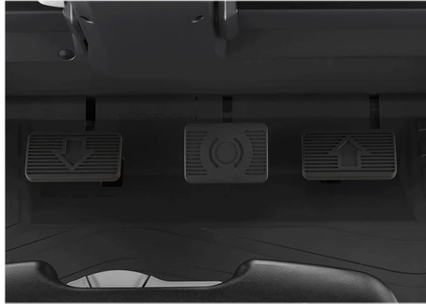
Existen diferentes distribuciones de pedales para adaptarse a las preferencias de los conductores. Los pedales de acelerador doble permiten al operador cambiar el sentido de la marcha con los pies.
