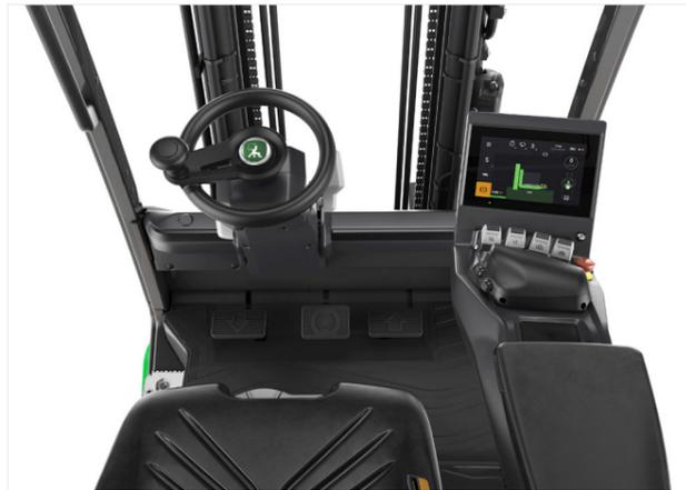
Aumento del confort del conductor con la nueva columna de dirección inclinable y telescópica, que mejora el espacio para el conductor.
