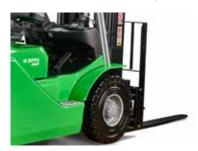
El escalón a baja altura, el asidero de gran tamaño y el amplio espacio para los pies permiten acceder fácilmente al compartimento del conductor
