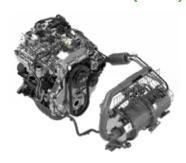
Este motor diésel industrial de 3 cilindros está montado en la M300 diésel de 2,0 a 3,5 toneladas. Cuenta con distribución accionada por cadena y ofrece un par muy elevado incluso a baja velocidad del motor gracias al turbocompresor de geometría variable.
